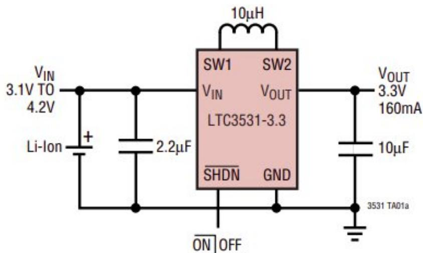
Figure 4 : Schéma application LTC3531-3V3 page 1 de la datasheet
