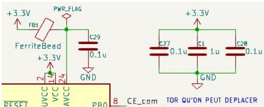
Ajout d'une ferrite et d'un condensateur. Permet de filtrer le bruit.
