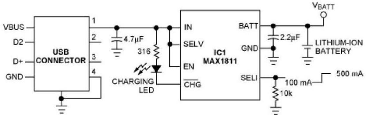
Figure 7 : Schéma design MAX1811
