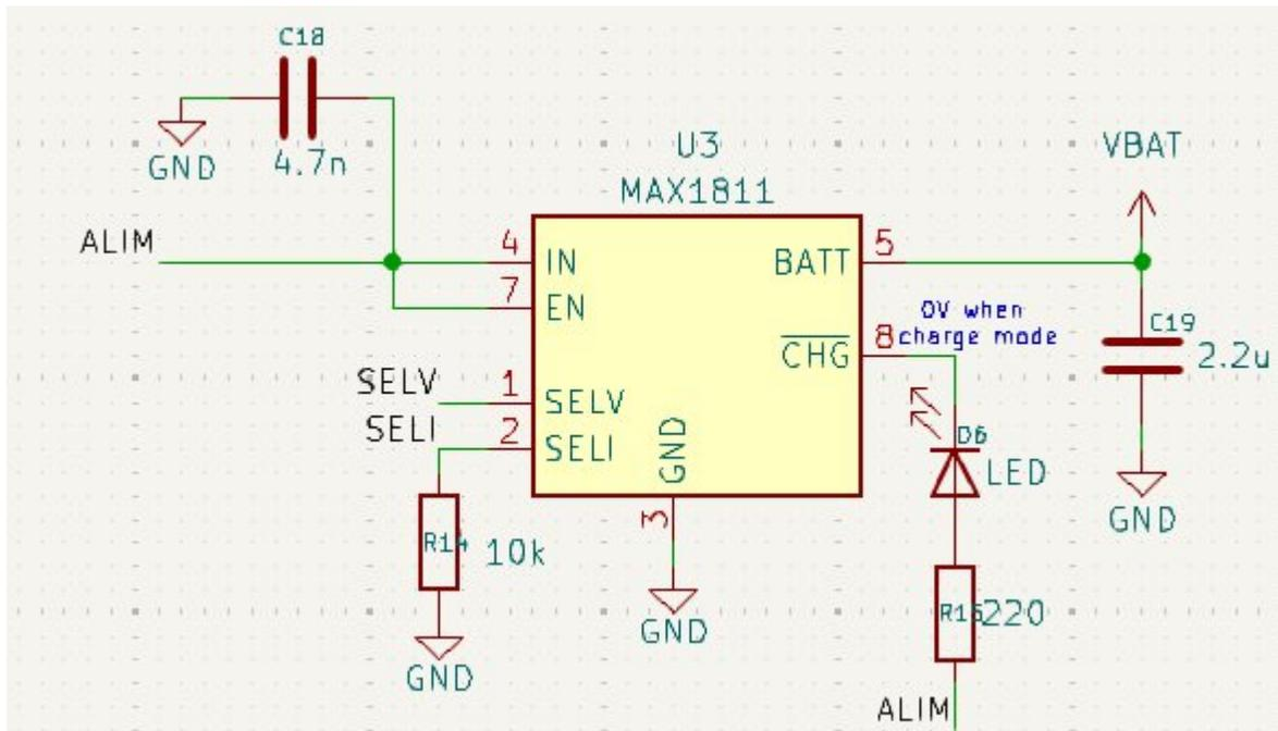
Figure 5 : Notre schéma kicad du MAX1811
