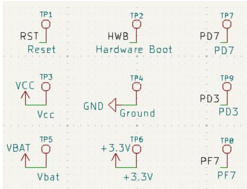
Permet de vérifier facilement toutes les tensions via des test points.
