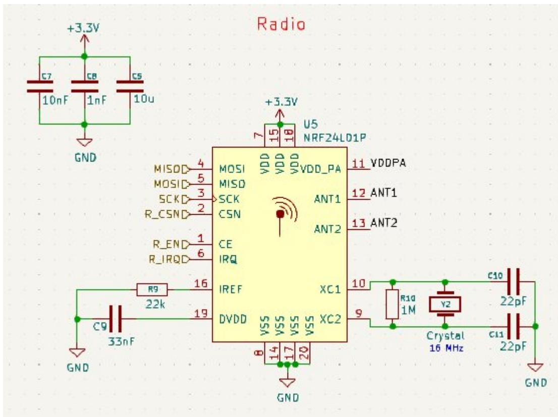
Figure 1 : Schéma application page 69 de la datasheet.
