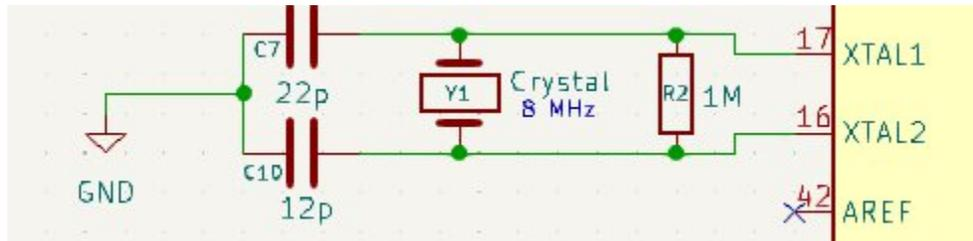
Figure 10 : Schéma kicad de la partie crystal du microcontrolleur
