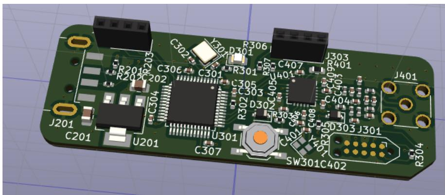
Figure 26. PCB de clé radio
